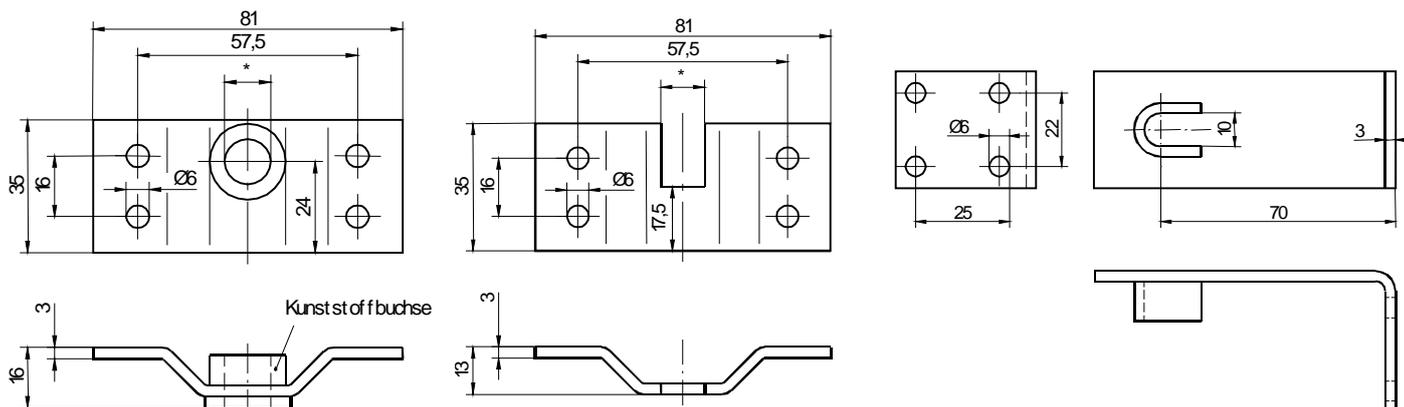
Träger Lagerseite für Federwelle 42 mm Rohr
