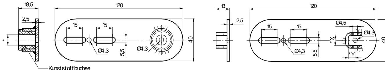
Träger Lagerseite lang für Federwelle 42 mm Rohr
