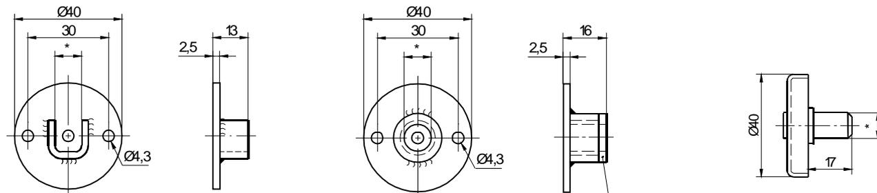
Träger Mechanikseite für Federwelle 42 mm Rohr
